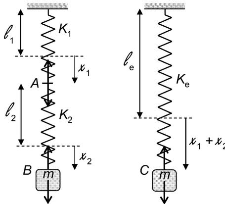
Soient  $l_1, l_2, l_e$  les longueurs à vide des ressorts 1, 2, et e (équivalent), et  $x_1, x_2, x_e$  leurs allongements respectifs. Pour résoudre ce problème on doit poser :  $l_e = l_1 + l_2$  et  $x_e = x_1 + x_2$  (voir figure ci-dessus). On écrit la condition d'équilibre en A, B et C :
